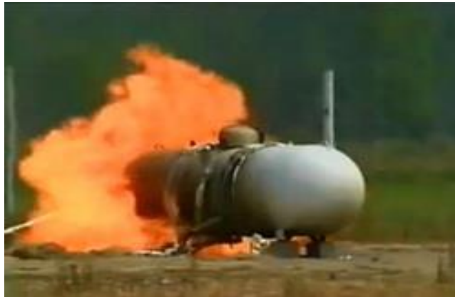
Figure.5.8. BLEVE explosion of LPG Tank [5].
